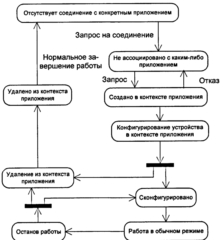
Рис. 3.11. Переход состояний виртуального медицинского устройства «Intellicard».
