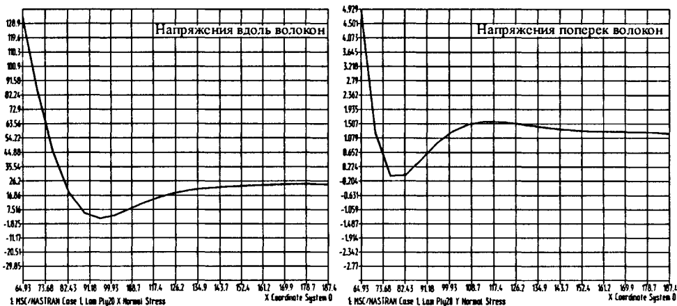
Рис.2.23. Распределение напряжений на верхней поверхности основной трубы в слое 20 (+45°)
