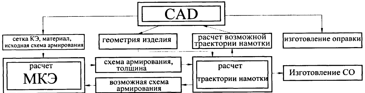
Рис. 4.2. Интеграция CAD, МКЭ, расчета схемы намотки
