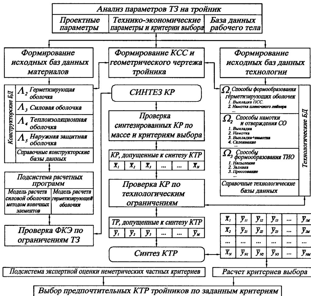
Рис. 3.1. Схема синтеза конструкторско-технологических решений тройника
