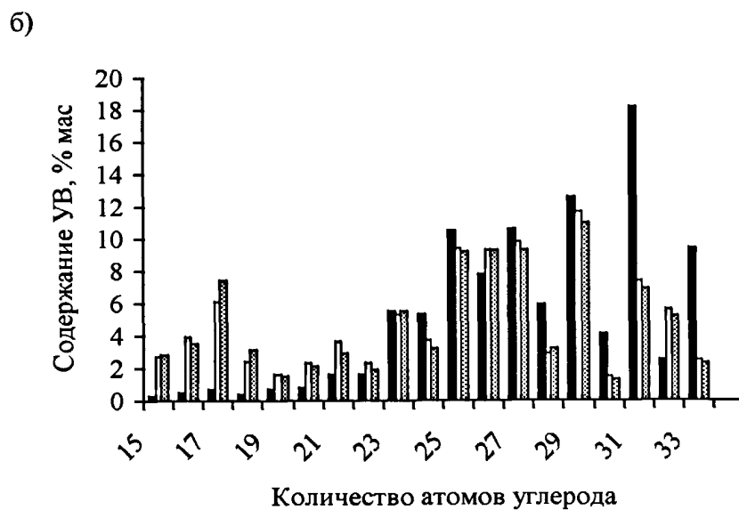
Рисунок 3.12 – Распределение углеводородов n-строения в битумах а) верхового и б) низинного торфов, обработанных в ВЦМ-10.
