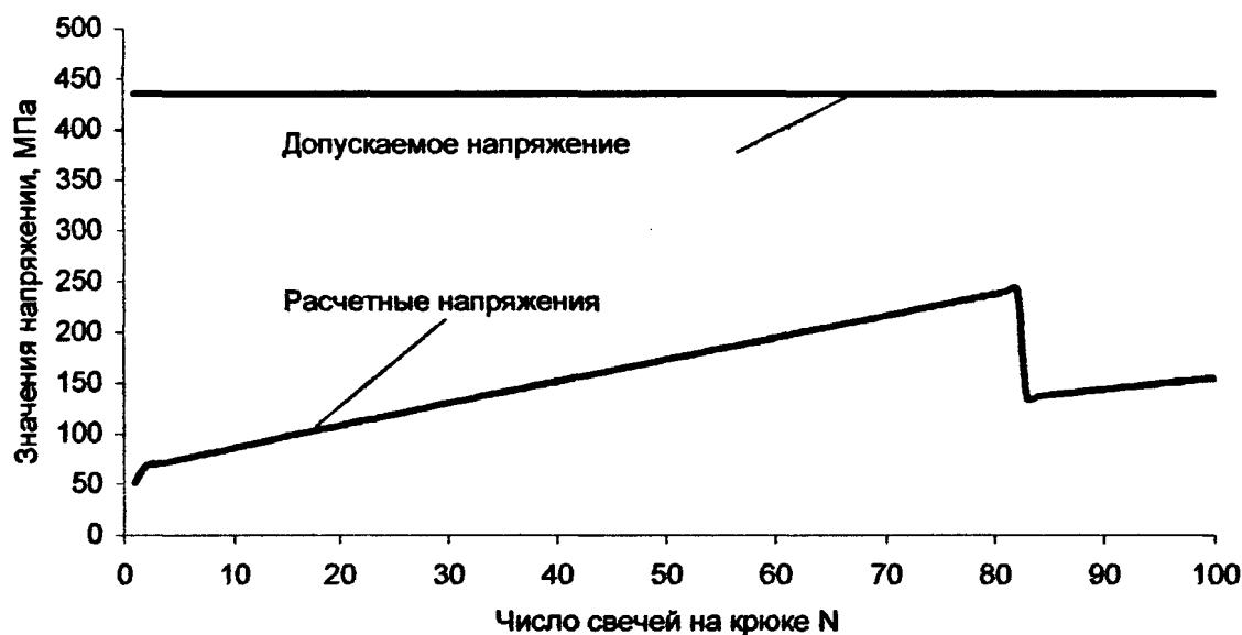
Рис. 3.4 Зависимость расчетного изгибного напряжения от числа свечей на крюке
