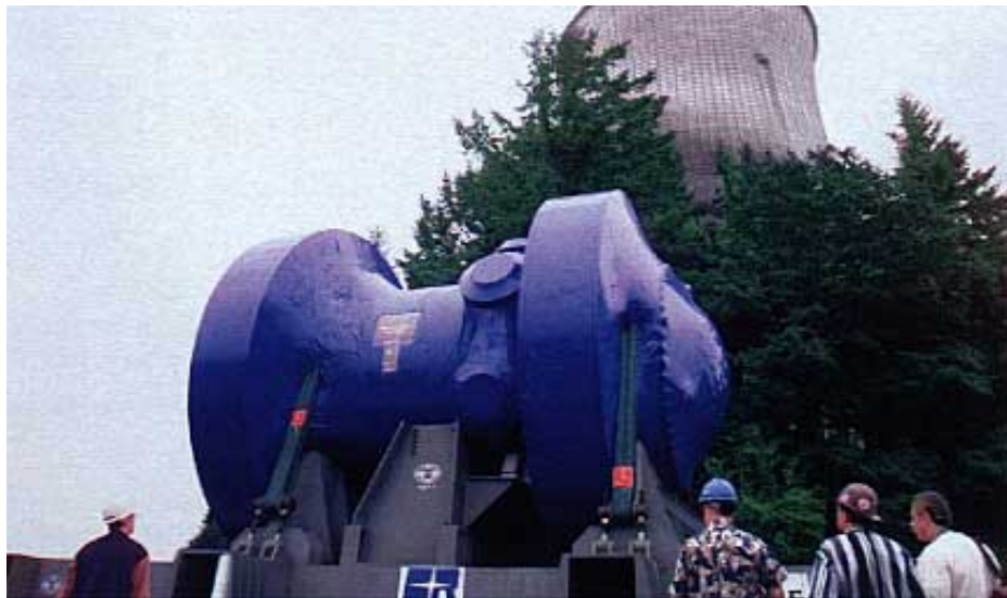
Reaktorverladung (beim Kernkraftwerk Trojan): Flussfahrt zur letzten Ruhestätte
