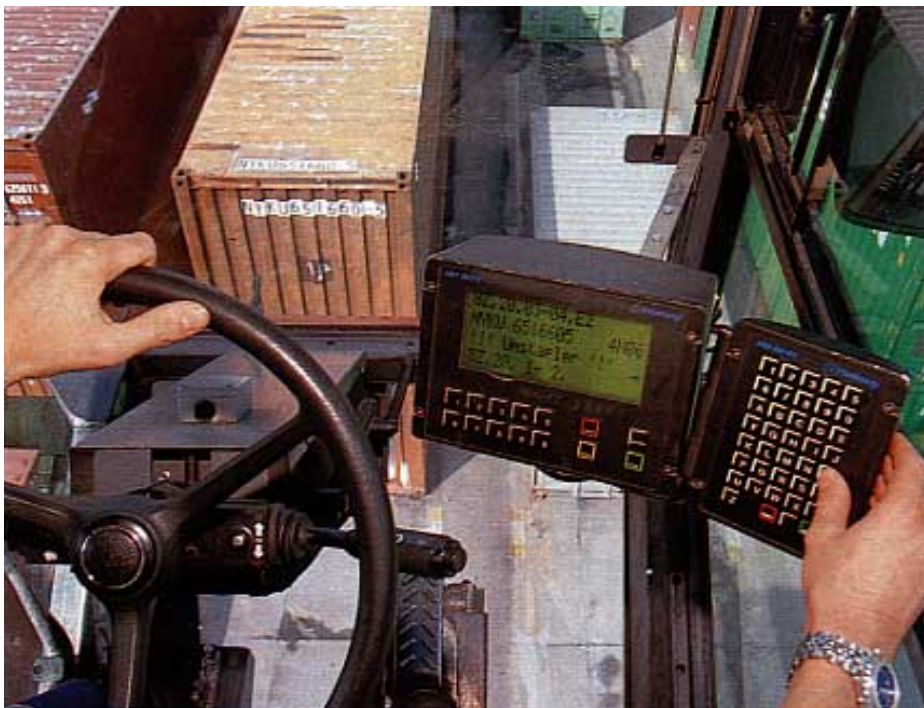
Satellitengesteuerter Containertransport* : Bis auf 50 Zentimeter genau
